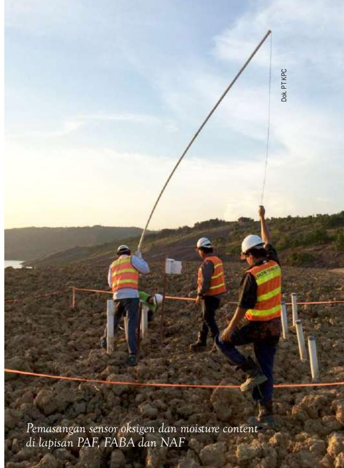
Pemasangan sensor oksigen dan moisture content di lapisan PAF, FABA dan NAF
